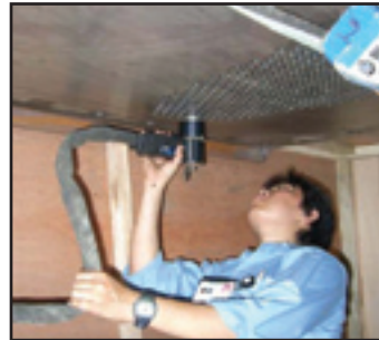
Modèle 430 - Application : soudures au plafond
