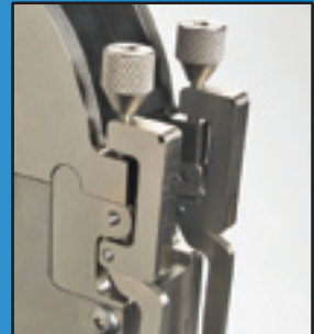
Réglage de la pression des ouvertures basculantes par vernier.
