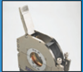
Un volet basculant s'ouvre pour permettre l'inspection finale du positionnement.
